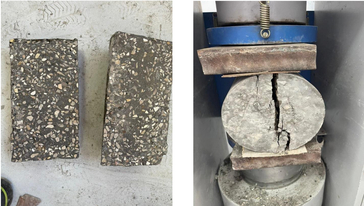
(c) (d) Fig 8.16 Brazilian tensile testing of concrete cylinders
