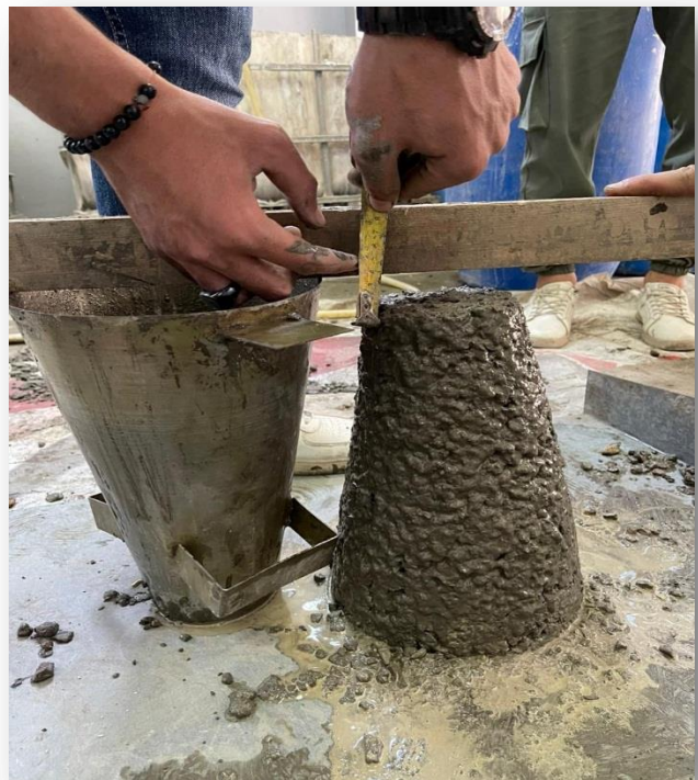
(c) (d) (e) Fig 8.14 slump test
