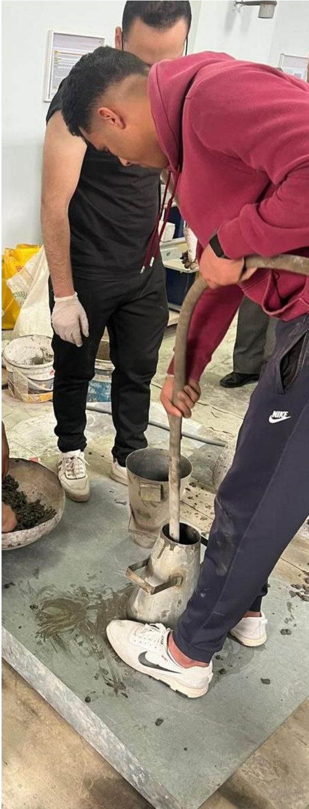
(c) (d) (e) Fig 8.14 slump test
